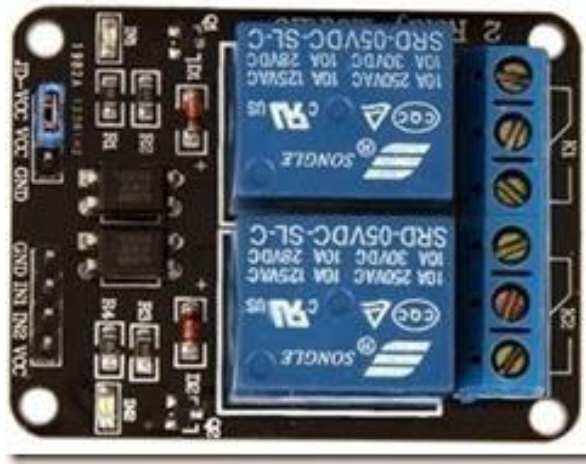
Şekil 3.7 5V 2-Kanallı röle modülü (Essabre-90xx-rpi, 2018)
