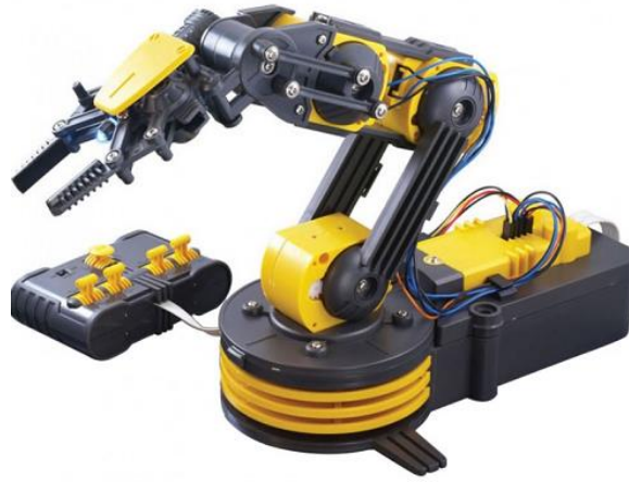
Şekil 5.6. OWI-535 robot kolu
