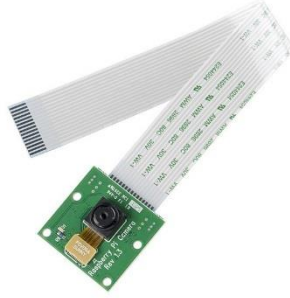
Şekil 5.4. Raspberry Pi kamera modülü
